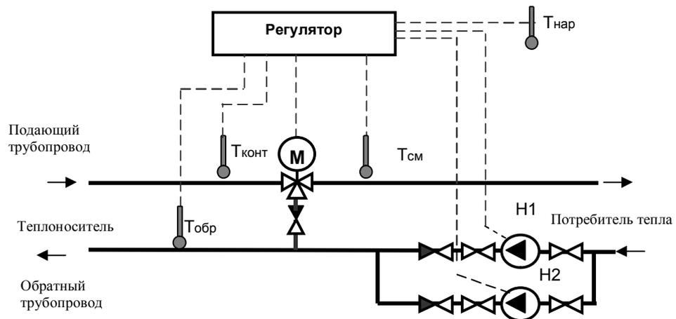
**б) Вариант с управлением трёхходовым регуливающим клапаном и двумя циркуляционными насосами в обратном трубопроводе зависимого контура отопления (максимальный набор оборудования)**
