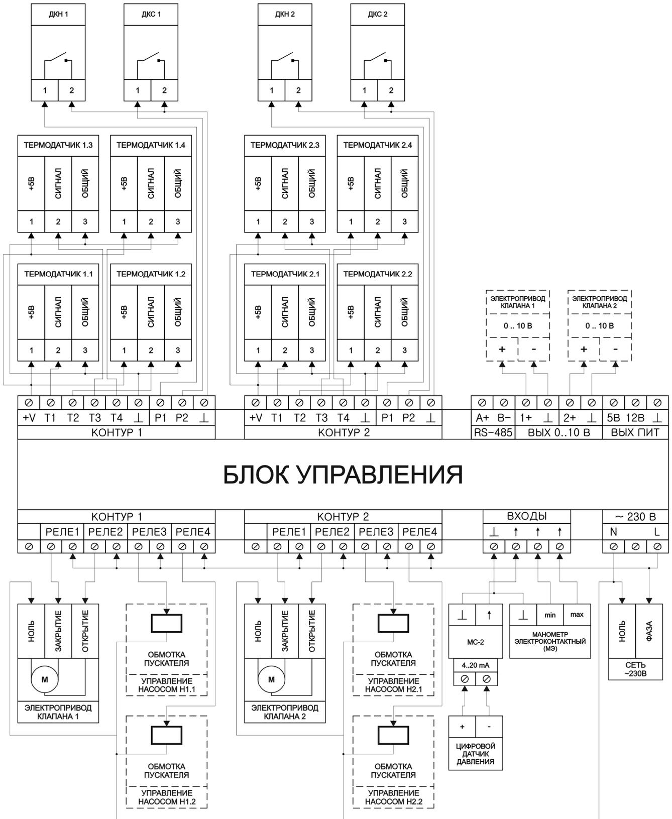
**Рисунок Б.1** Схема электрическая подключений регулятора
