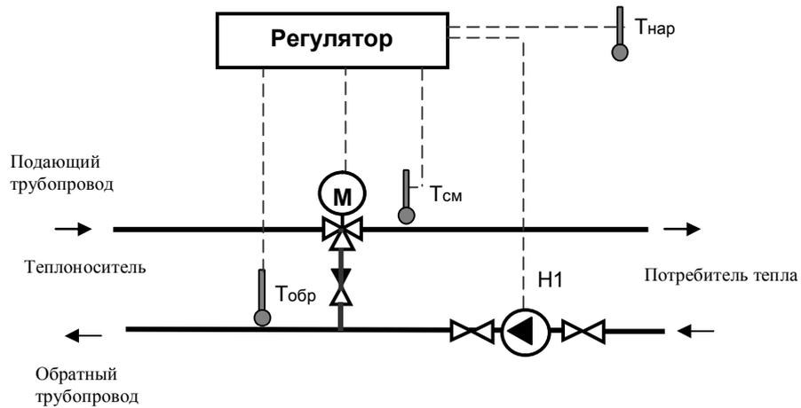
**а) Вариант с управлением трёхходовым регуливающим клапаном и циркуляционным насосом в обратном трубопроводе зависимого контура отопления (минимально-допустимый набор оборудования)**
