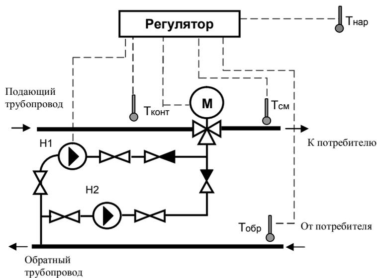
**б) Вариант с управлением двумя подмешивающими насосами и трёхходовым регулирующим клапаном (максимальный набор оборудования)**
