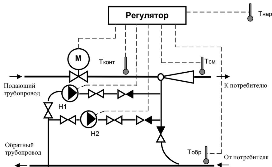
**б) Вариант с управлением двумя подмешивающими насосами и двухходовым клапаном (максимальный набор оборудования)**
