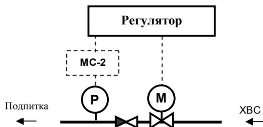
**а) Вариант схемы поддержания требуемого давления в линии подпитки без повысительных насосов**
