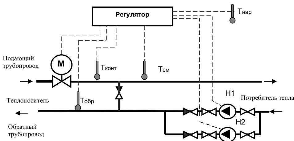
**б) Вариант с управлением двухходовым регулирующим клапаном и двумя циркуляционными насосами в обратном трубопроводе зависимого контура отопления (максимальный набор оборудования)**
