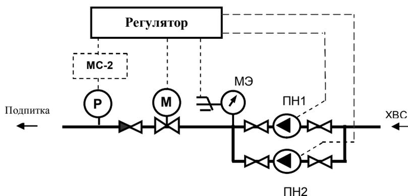
**б) Вариант схемы с повысительными насосами**
