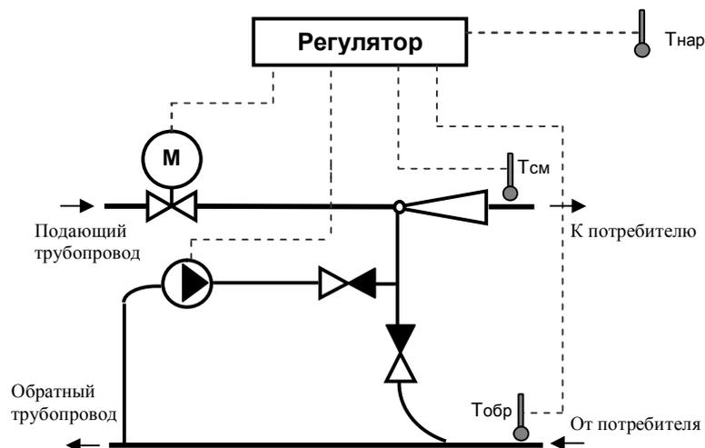
**а) Вариант с подмешивающим насосом и двухходовым регулирующим клапаном (минимально-допустимый набор оборудования)**
